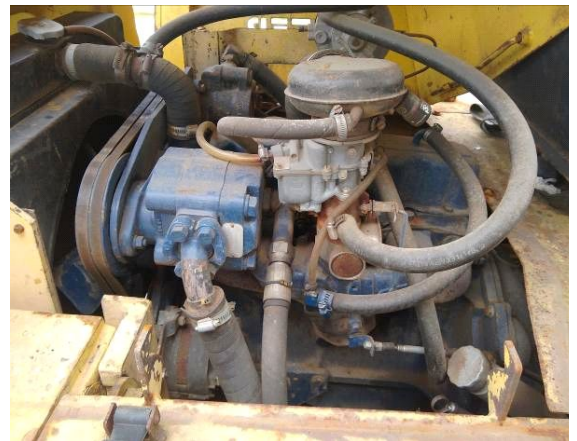
FOTO 10: Motor GM 4 cilindros de empilhadeira Hyster.
