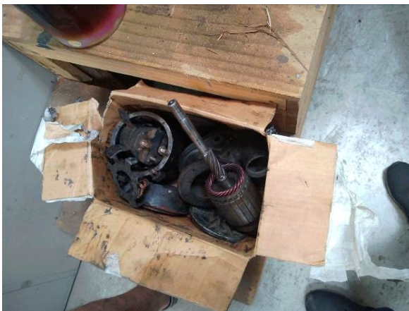
FOTO 11: Peças do motor de arranque de empilhadeira Hyster.
