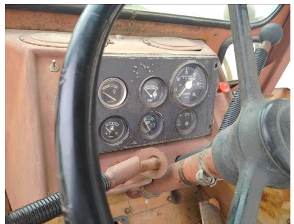
FOTO 06: Painel da retro escavadeira com horímetro marcando 768,8 horas.
